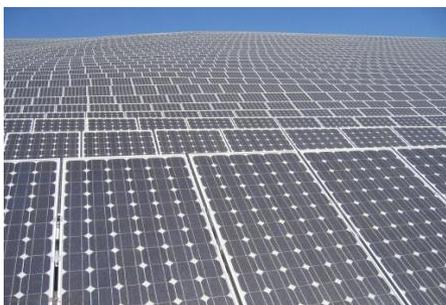
中电投青海单晶系统与多晶比较，单晶每瓦发电量比多晶高 **4.77%**
